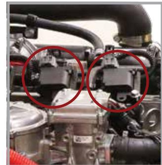
Diseño de encendido de bobina sobre bujía
