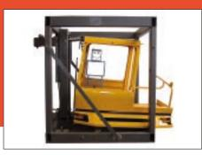
La estructura de la cabina es completamente de acero, espaciosa y segura (cumplen certificación FOPS y ROPS) asegurando máxima protección al conductor
