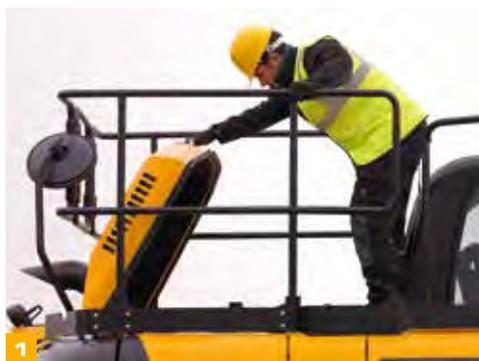
**1** El capó de la excavadora JS115/I30/I45 se abre de adelante hacia atrás lo que proporciona un acceso fácil y seguro para el mantenimiento del motor.
