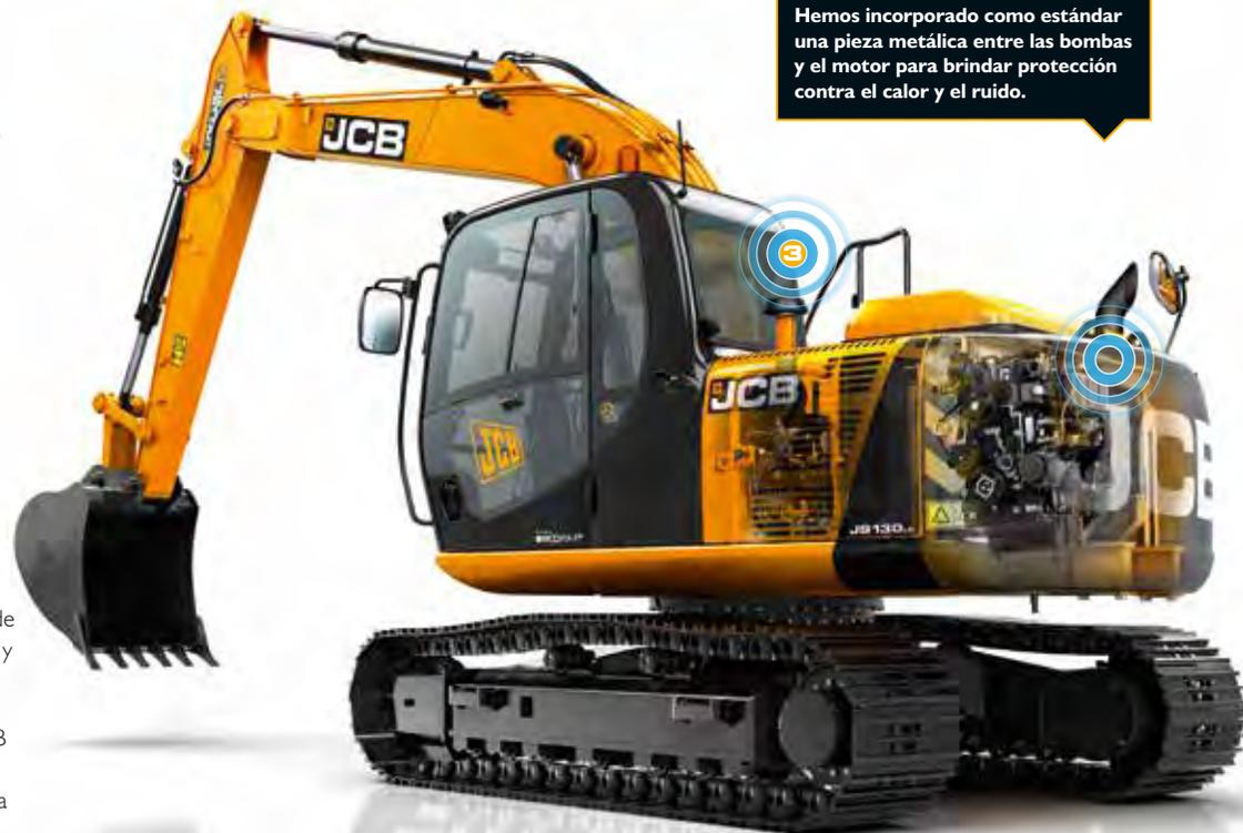
Hemos incorporado como estándar una pieza metálica entre las bombas y el motor para brindar protección contra el calor y el ruido.
