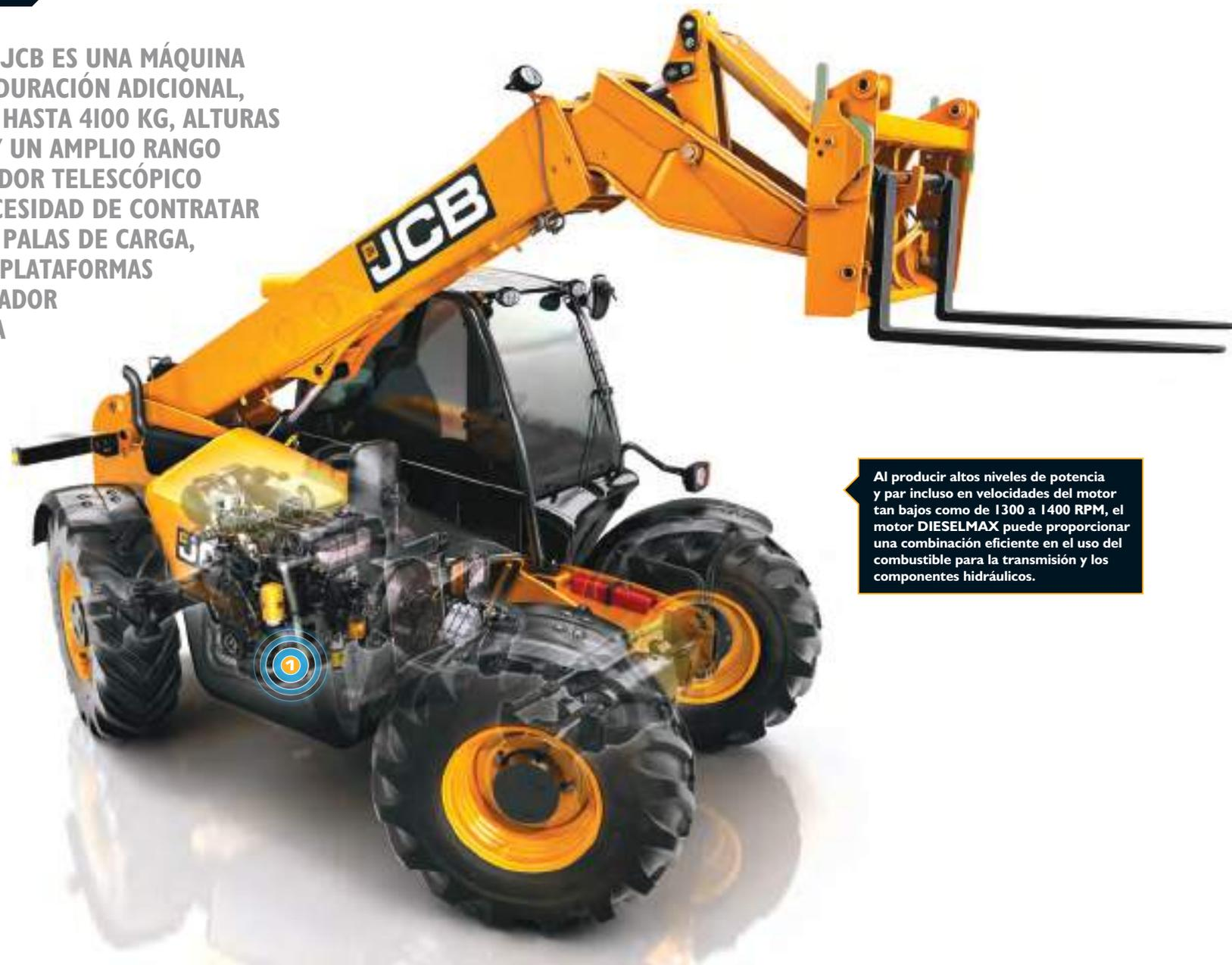
Al producir altos niveles de potencia y par incluso en velocidades del motor tan bajas como de 1300 a 1400 RPM, el motor DIESELMAX puede proporcionar una combinación eficiente en el uso del combustible para la transmisión y los componentes hidráulicos.
