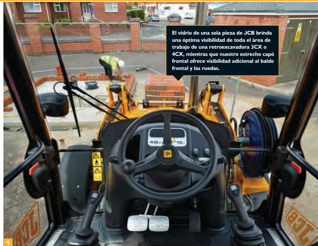
El vidrio de una sola pieza de JCB brinda una óptima visibilidad de toda el área de trabajo de una retroexcavadora 3CX o 4CX, mientras que nuestro estrecho capó frontal ofrece visibilidad adicional al balde frontal y las ruedas.
